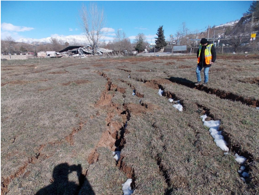
Şekil 4.37 Adıyaman Gölbaşı ilçesi yumuşak kil tabaka yanıl deformasyonlar (göle doğru)
