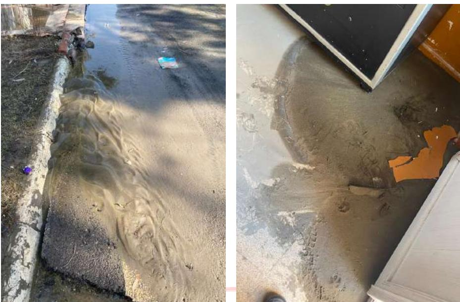
Şekil 4.54. Sismik zemin sıvılaşmasının yüzey belirtileri kum kaynamaları
