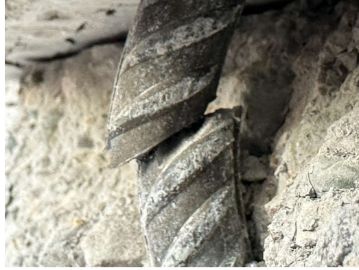
Şekil 18 Gevrek davranış sergileyerek kırılan donatı
