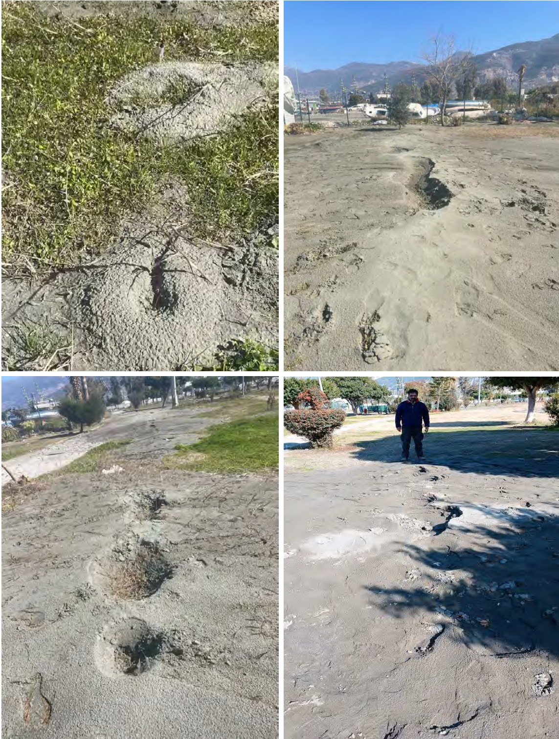
Şekil 80. İskenderun Hatay, sismik sıvılaşmaya bağlı kum kaynamaları
