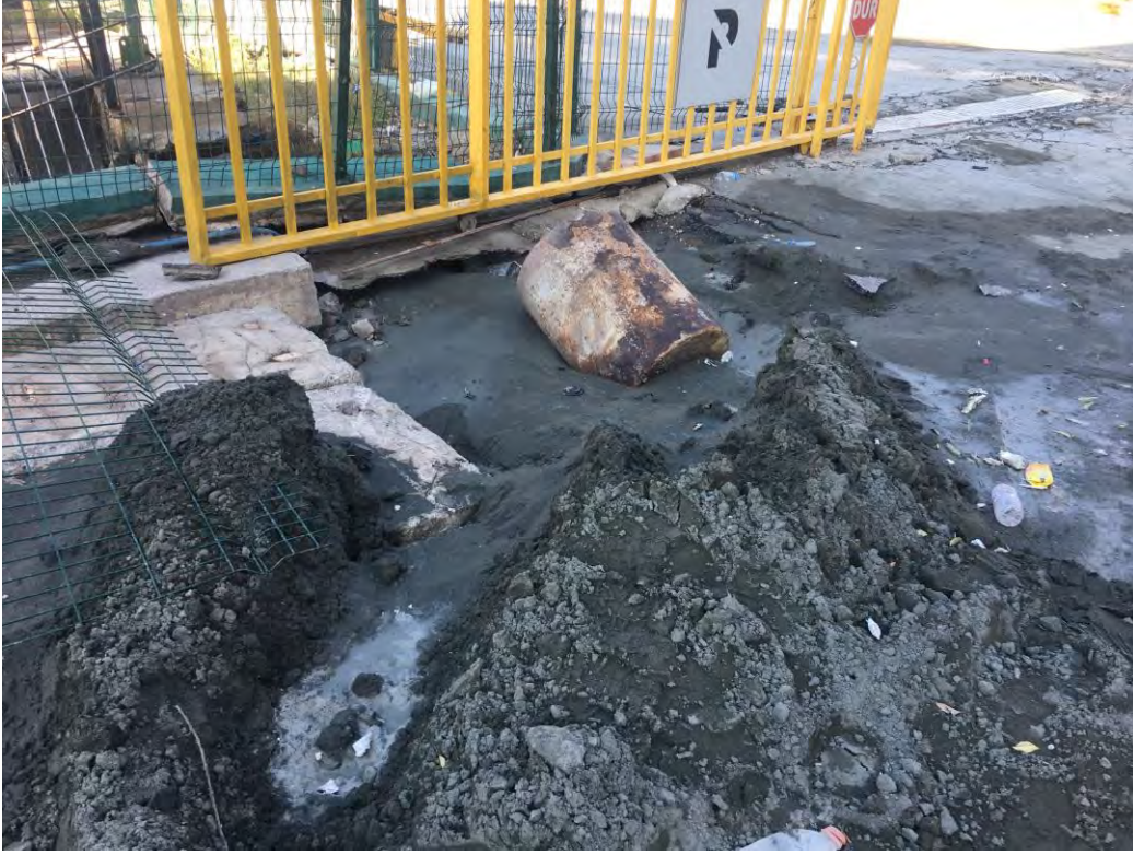
Şekil 77. İskenderun Hatay, sismik sıvılaşmaya olarak yüzeye çıkan kum birikintileri
