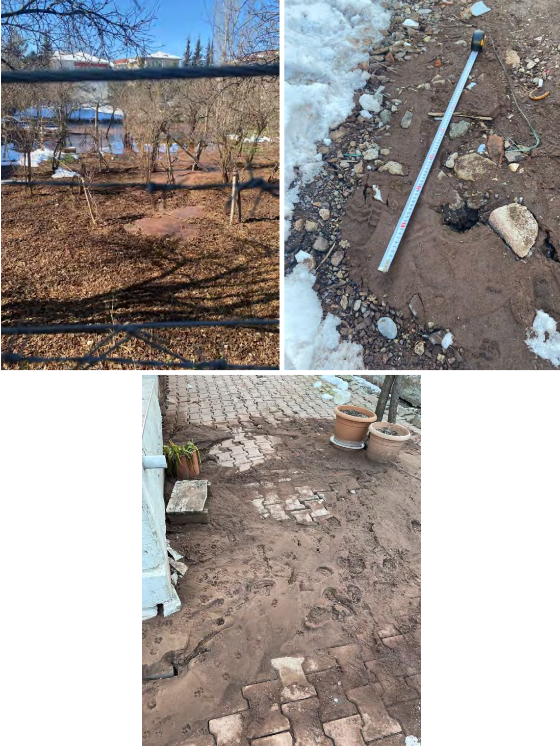
Şekil 31. Adıyaman ili Gölbaşı ilçesinde gözlemlenen kum kaynamaları
