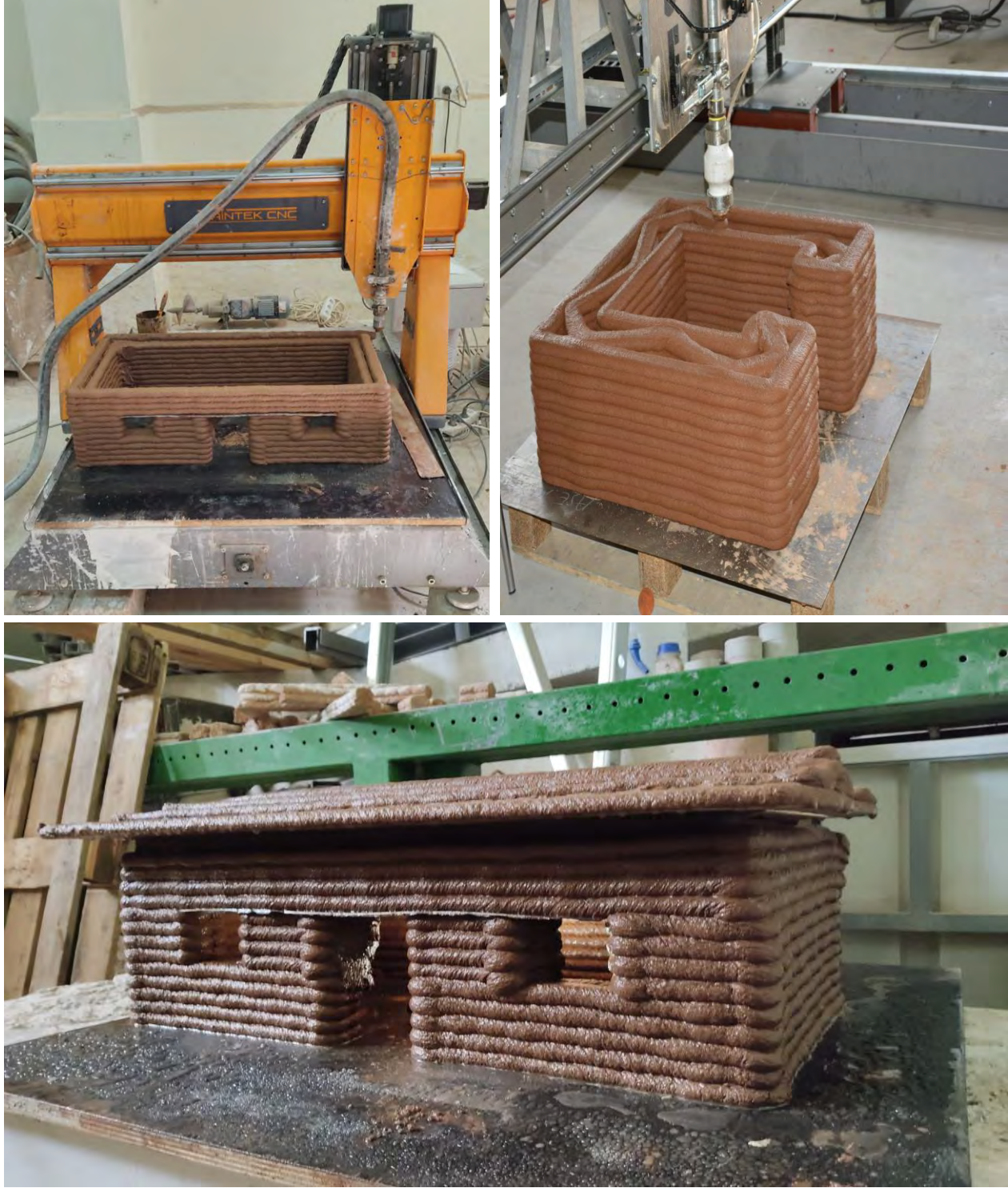
Şekil 119. Üç boyutlu eklemeli imalat ile inşa edilen laboratuvar ölçeğindeki yapı örneği
