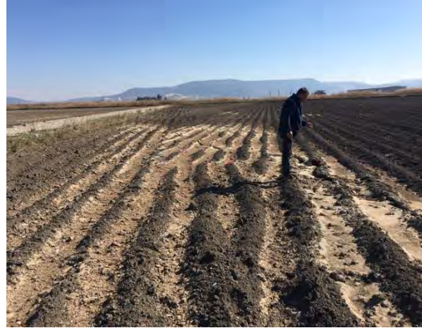
Şekil 98. Türkoğlu bölgesinde zemin sıvılaşması kaynaklı kum kaynamaları
