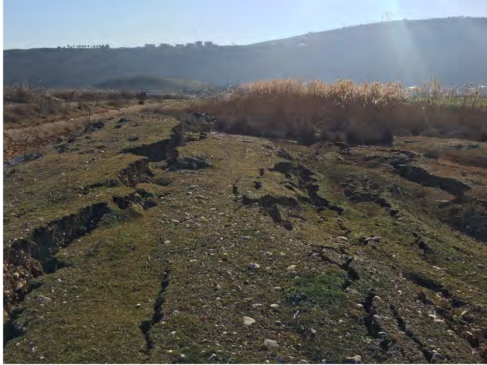
Şekil 102. Pazarcık bölgesinde dere yatağı boyunca yanıl yayılmalar
