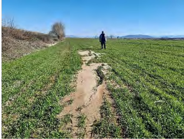
Şekil 98. Türkoğlu bölgesinde zemin sıvılaşması kaynaklı kum kaynamaları
