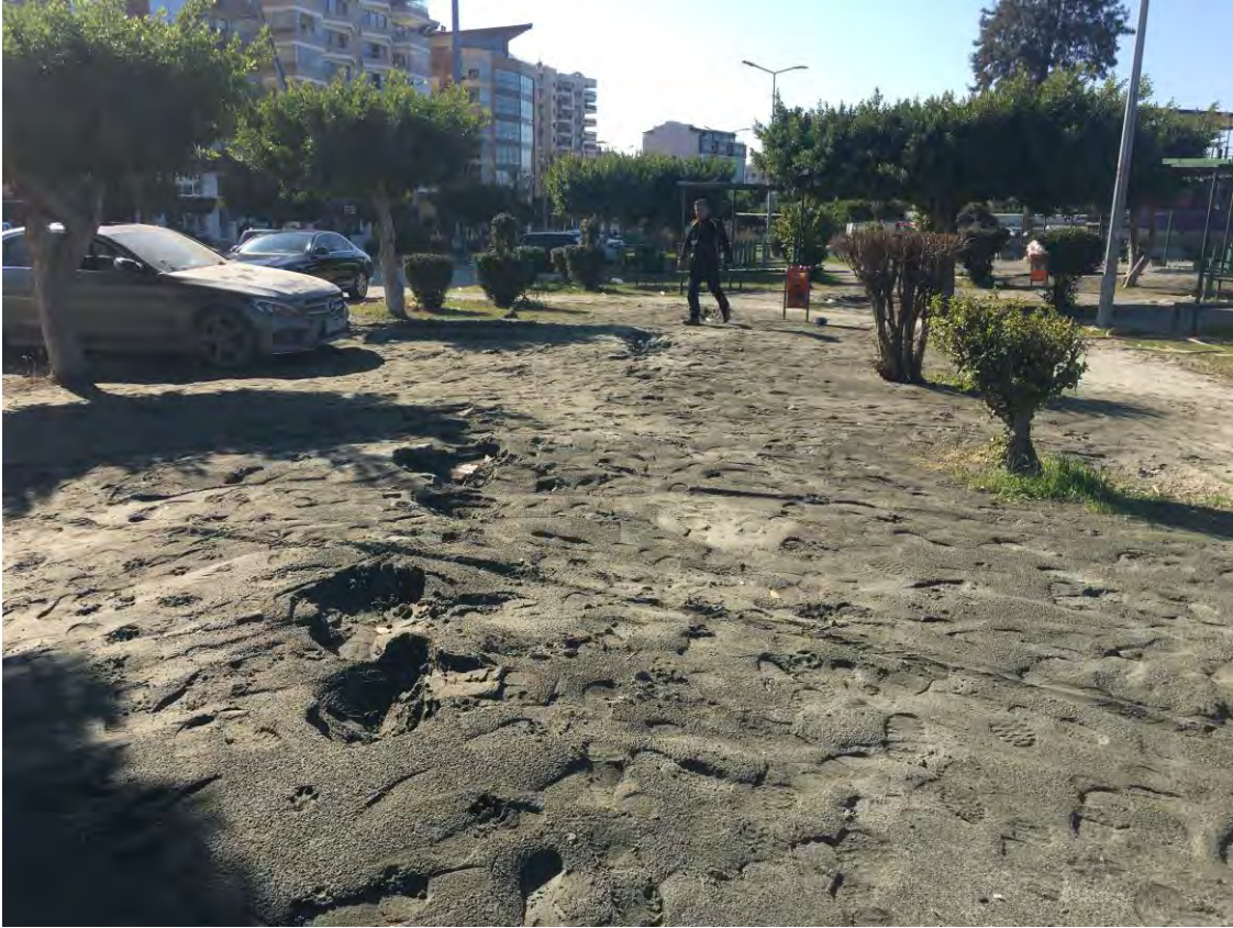
Şekil 76. İskenderun Hatay, sismik sıvılaşmaya bağlı kum kaynamaları ve yüzeye çıkan kum birikintileri
