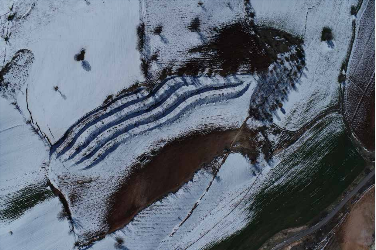
Şekil 1.27. Şahin tepesi civarında farklı doğrultulara sahip kırık hattının İHA görüntüsü
