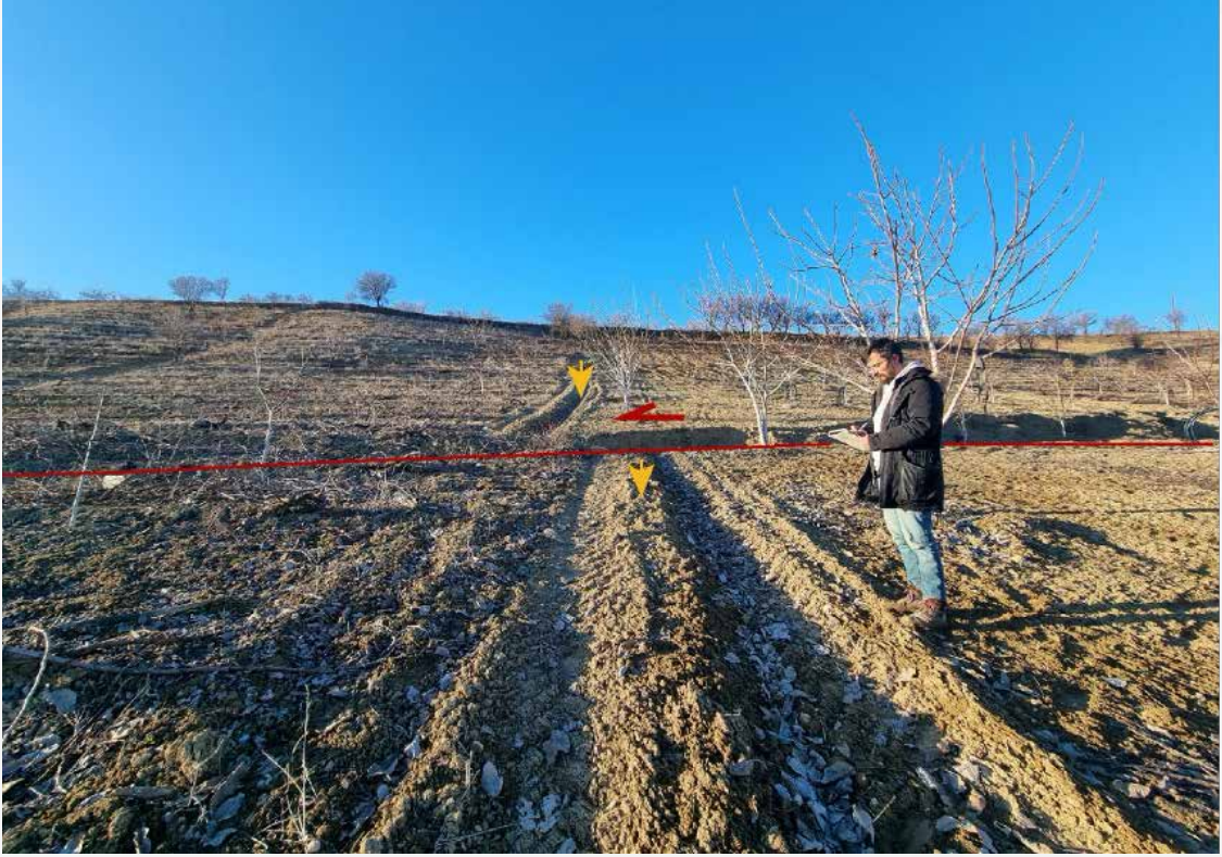
Şekil 1.22. Balkar'da yüzey kırığı boyunca bir tarlada 325 \pm 15 cm yanal ve 70 cm düşey atım gözlenmiştir.
