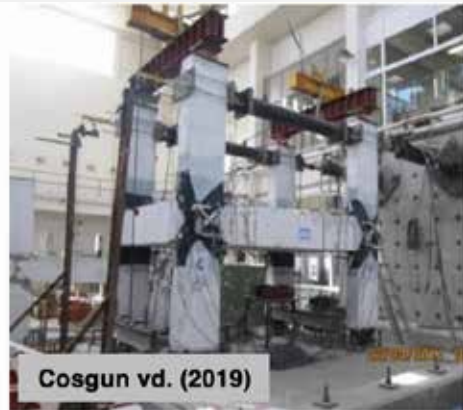
Şekil 4.6. İTÜ'de yapılan lifli polimer ile güçlendirme çalışmalarından örnekler (Bedirhanoğlu 2009, Ghatte et al. 2015, Cosgun vd. 2019, Seyhan vd. 2023)
