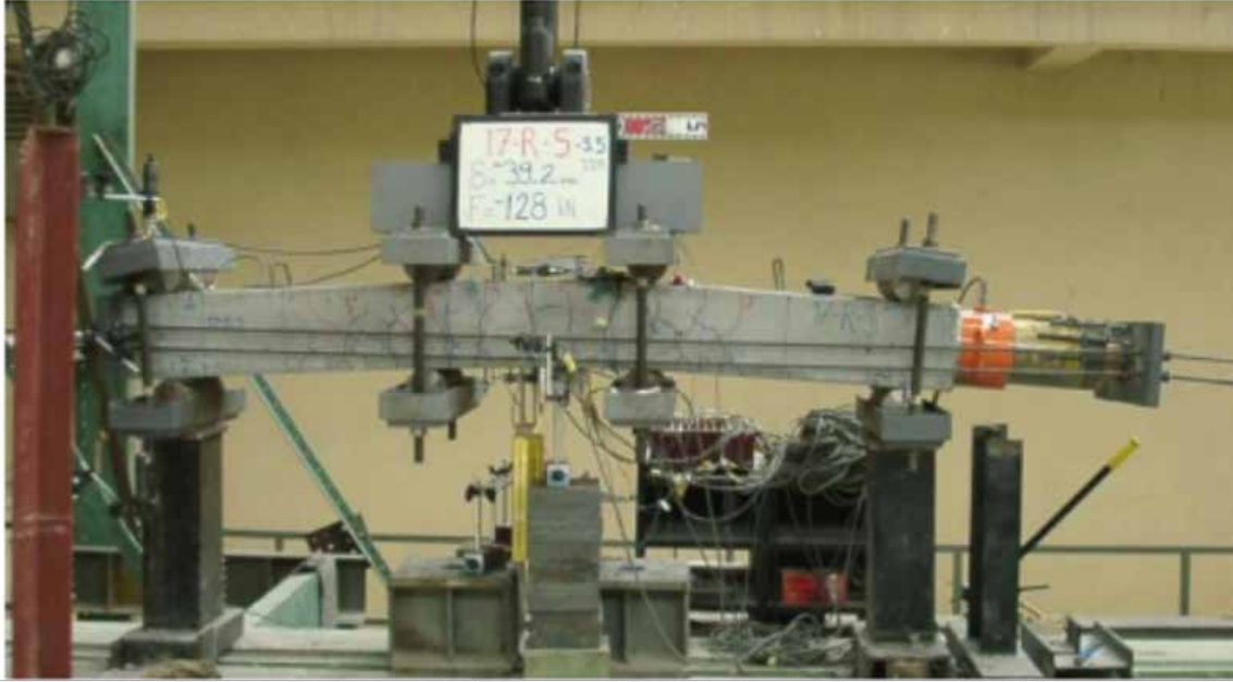
Şekil 4.5. İTÜ'de betonarme mantolama ile yapılan güçlendirme örneği (Demir, 2004)
