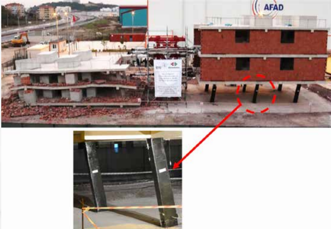
Şekil 4.8. Lifli polimer sargılama ile güçlendirilmiş betonarme kolonların deprem davranışının belirlenmesine yönelik yapılan tam ölçekli bina deneyleri (Ilki vd. 2018)
