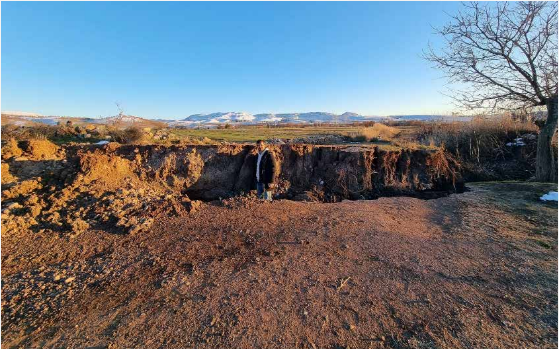
Şekil 1. 23. Balkar batısında ölçülen 150 cm'lik düşey atım
