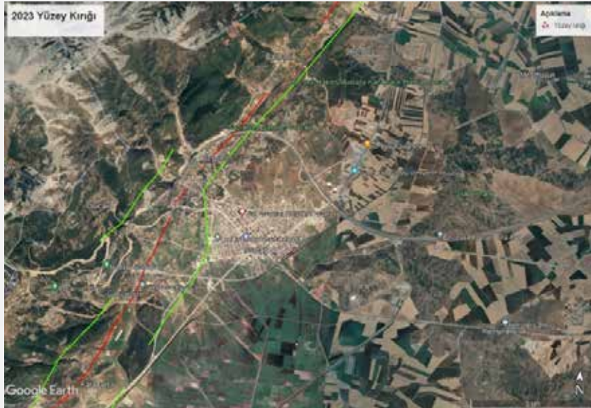
Şekil 1.4. a) Uydu görüntüsünden yapılan aktif fay izi ve yüzey kırıkları dağılımı (üstteki) (Tarı-Yaltrak) b) MTA aktif fay haritası (yeşil) ile yüzey kırığının farklılığı (alttaki) (kırmızı çizgiler).
