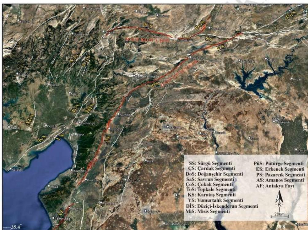
**Şekil 1.1.** Doğu Anadolu Fay Zonu'na ait segmentasyon ve bölgedeki diğer önemli yapısal unsurlar (Duman ve Emre, 2013; Duman vd., 2020). Beyaz renkle gösterilen sismik kaynaklar Emre ve diğ. (2013)'den alınmıştır. Kırmızı hatla belirtilen çizgiler, Şubat 2023 7,7; 7,6 ve 6,4 depremlerinde kırılan segmentleri simgelemektedir.
