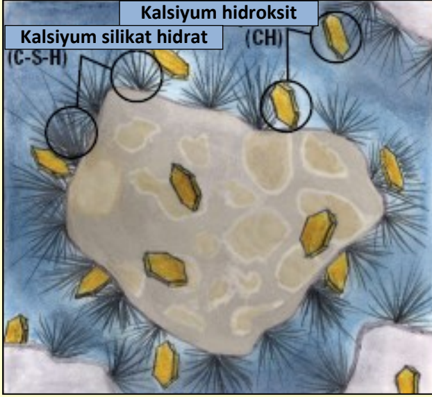
Şekil 14: C-S-H ve CH oluşumu[1]
