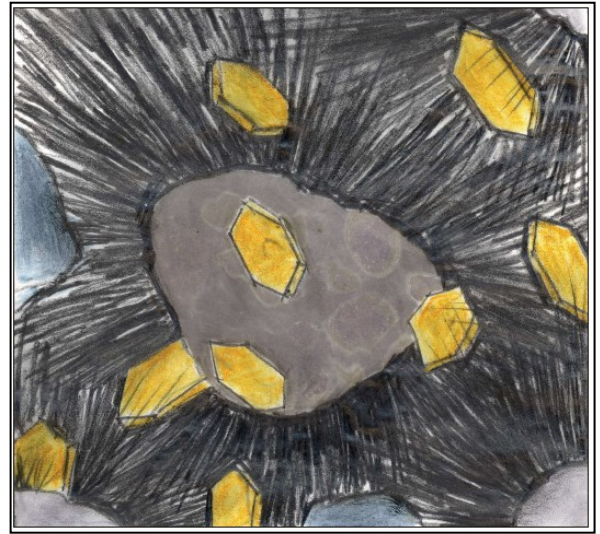
Şekil 7-8-9: Hidratasyon süreçleri boyunca çimento hamurundaki değişim[1]
