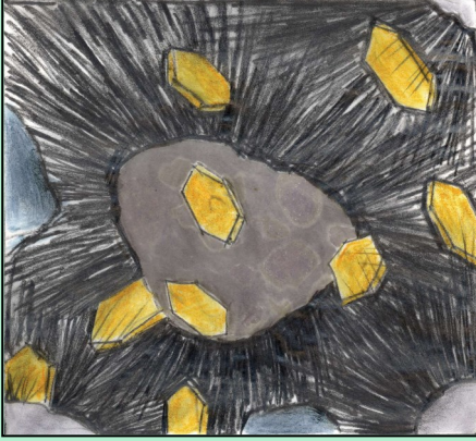
Şekil 16: Çimento ürünlerinin zamanla yoğun bir yapı oluşturması[1]
