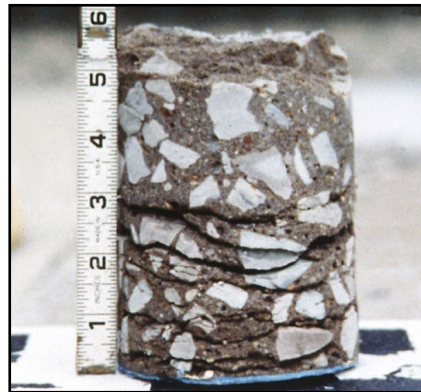
Resim 32-33: Donma-Çözülme etkisi sonucu betonun görünümü
